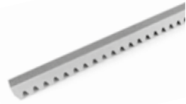
CRIS 600 Cremagliera M6 30x30x1000 mm zincata, a saldare, da accoppiare alla corona M600
